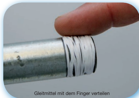
2-3 Tropfen des Gleitmittels (in herausnehmbarem Boden) auf den Dichtfaden geben - biologisch abbaubar
