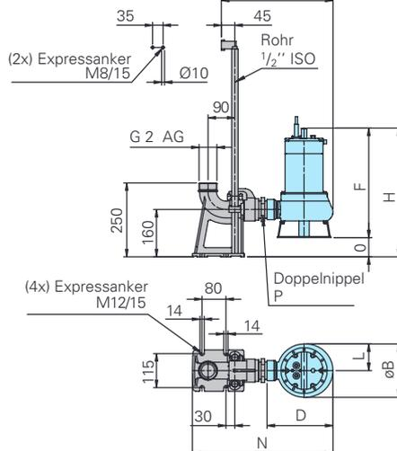
**Nassaufstellung mit Kupplungssystem DN65 PN10**
