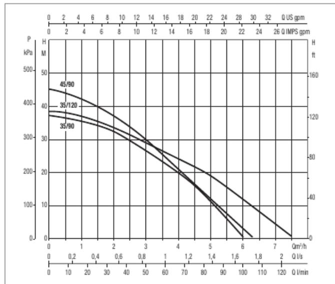
Die Kurven basieren auf eine Viskosität = 1 mm²/s und einer äquivalenten Dichte von 1000kg/m³.
