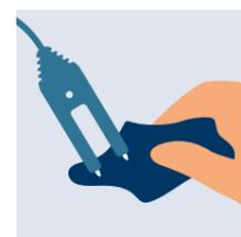
Kontrollieren Sie in regelmäßigen Abständen die Messspitzen des Wassersensors. Reinigen Sie die Metallenden bei Bedarf mit einem feuchten Tuch. Überprüfen Sie regelmäßig die korrekte Funktion des WD 1000,
